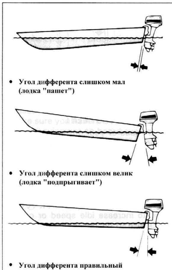
Для достижения устойчивого управления и наилучшего режима функционирования, необходимо постоянно поддерживать правильный угол дифферента, как это показано на рисунке. Нужный угол дифферента меняется в зависимости от того, какая лодка, какой двигатель и гребной винт, а также каково рабочее состояние оборудования.
